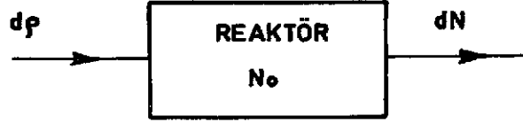
Şekil : VI. 9. d\rho luk bir reaktiflik değişikliğinin dN lik bir nötron seviyesi değişikliği doğurduğunu gösteren şema.
